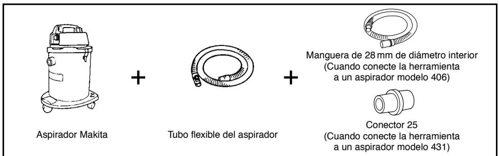
Cuando conecte el aspirador de polvo Makita (Modelo 420), no necesitará el tubo flexible ni el conector opcional. Podrá conectar la lijadora de banda directamente al tubo flexible del aspirador de polvo.
