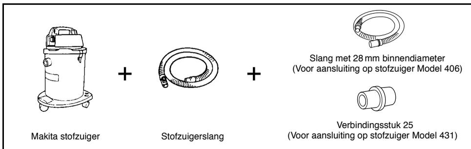
Om aan te sluiten op de Makita stofvanger (Model 420), is de optionele slang of het verbingsstuk niet nodig. U kunt de bandschuurmachine direct aansluiten op de slang van de stofvanger.
