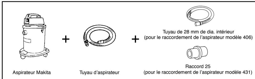
Pour le raccordement à l'aspirateur Makita (modèle 420), le tuyau ou le raccord en option ne sont pas nécessaires. Vous pouvez raccorder la ponceuse à bande directement au tuyau du collecteur de poussière.
