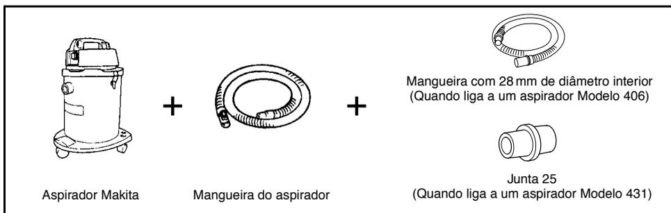
Quando liga ao aspirador Makita Modelo 420 não necessita da mangueira ou junta opcional. Pode liga a lixadora de braçadeira directamente à mangueira do aspirador.
