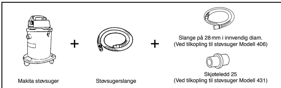
Ved tilkopling til Makita støvsamler (Modell 420), er den ekstra slangen eller skjoteleddet ikke nødvendig. Båndsliperen kan koples direkte til slangen på støvsamleren.
