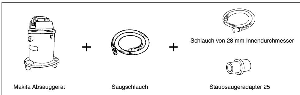
Zum Anschluß an ein Makita-Absauggerät wird ein gesonderter Schlauch von 28 mm Innendurchmesser oder ein Staubsaugeradapter 25 benötigt. Siehe Abbildung unten.
