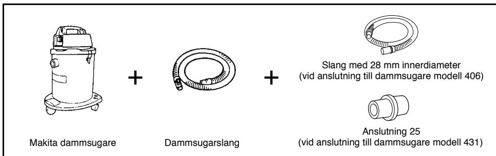
Vid anslutning till en Makita dammuppsamlare (modell 420) behövs inte den separata slangen eller anslutningen. Du kan ansluta bandslipmaskinen direkt till dammuppsamlarens slang.
