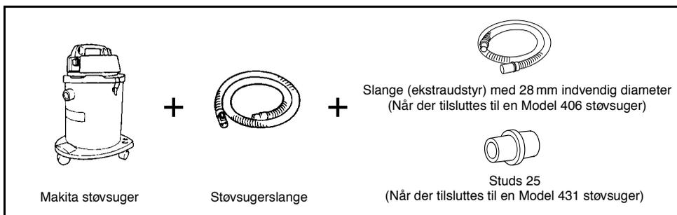
Når der tilsluttes til en Makita støvsopsamler (Model 420), er ekstraudstyrsslangen og studsene ikke nødvendige. De kan tilslutte båndsliberen direkte til slangen på støvsopsamleren.
